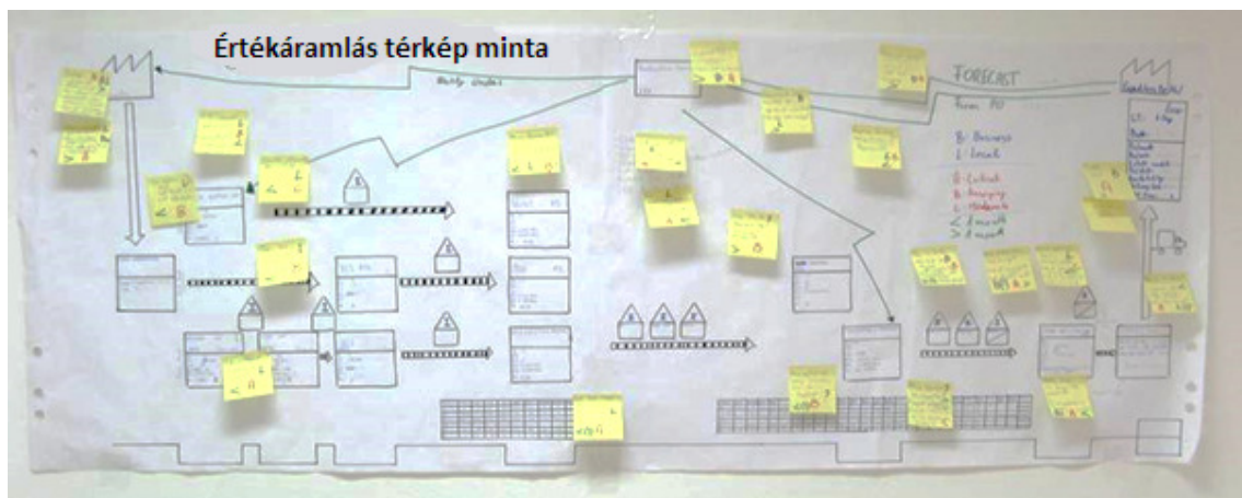
35. ábra Faltól falig értékáramlás térkép az anyag, a termék, valamint az információ áramlásának feltérképezésére
